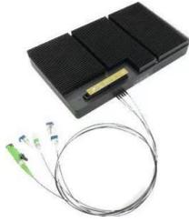
拉曼放大器利用受激拉曼原理,后置拉曼可以实现 10~30dB 左右增益多波放大。增益平坦 $\leq 1.5\text{dB}$ ,噪声 $\leq 0\text{dB}$ 。拉曼放大器还包括 2 阶拉曼,前向拉曼等应用。
