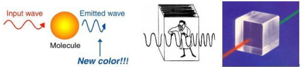
图8 非线性光学晶体激光变频过程示意图
