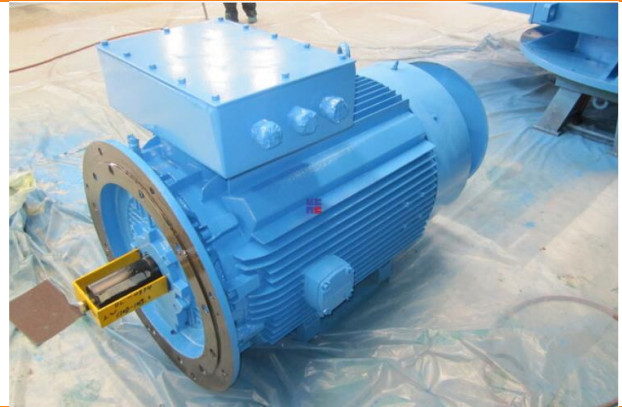
图 19：公司 HY80-355 系列安全级 K3 类 380V 核电厂用电动机
