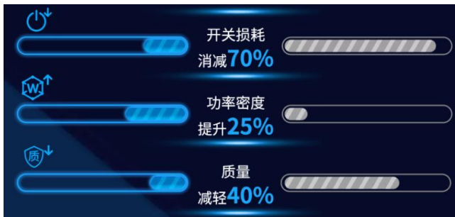
图13：碳化硅与硅基半导体性能对比 2
