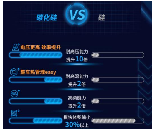
图12：碳化硅与硅基半导体性能对比 1
