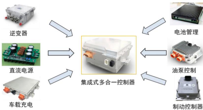
图14：电控模块多功能的集成趋势
