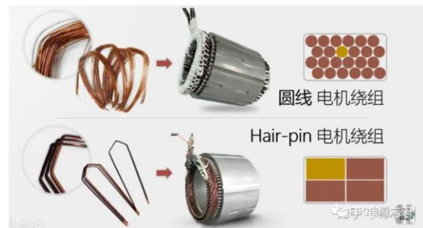
图16：Hair-pin 绕组方式更高的槽满率
