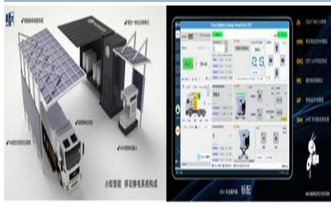
图表47：公司无轨智能重卡换电系统及配置示意图
