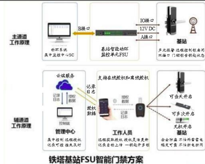
图14: FSU在主通道出现故障或断电断网状态下,用辅助通道,工作人员授权开门
