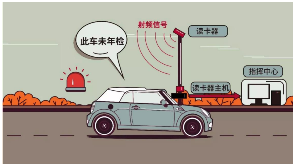
图 15: 电子车牌可以协助智慧交通系统获知汽车实时情况
