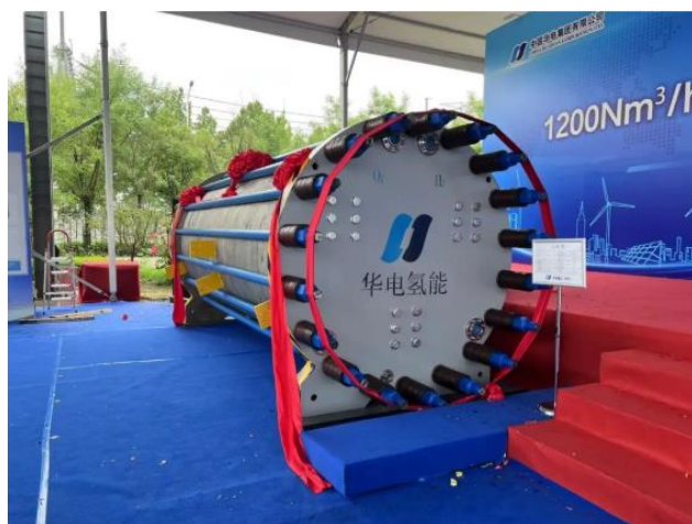
图表 86: 1200Nm 3 /h 碱性电解水制氢装置
