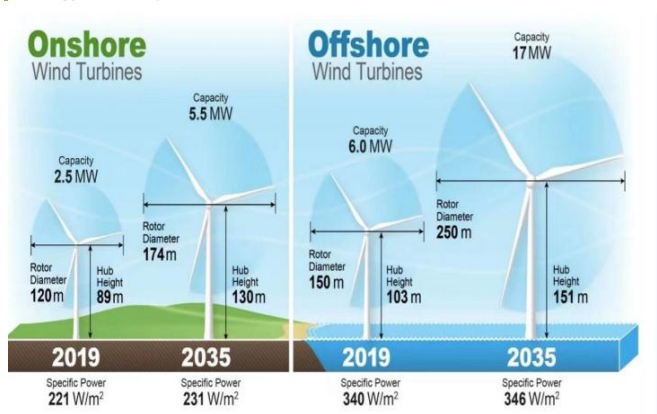
图 10：塔筒高度受风机功率提升而增大
