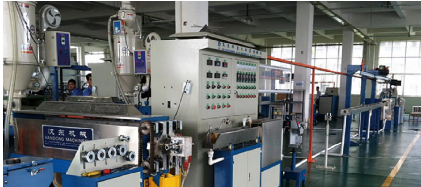
图 25：自交联低烟无卤电缆工艺
