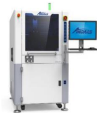
图 14：安达智能 iCoat-3 选择性涂覆机
