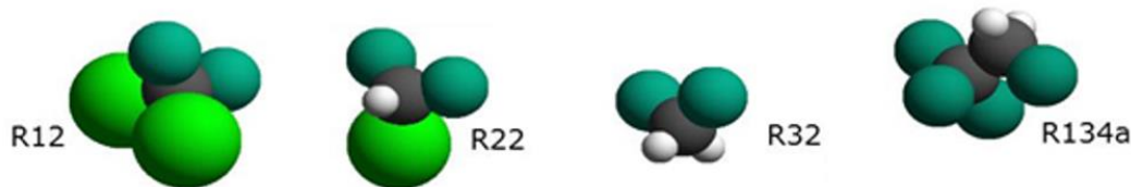
图表 22: R12、R22、R32、R134a 分子结构 (浅绿色为氯原子)
