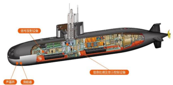
图 7 水声信息传输装备在水下舰艇中的应用
