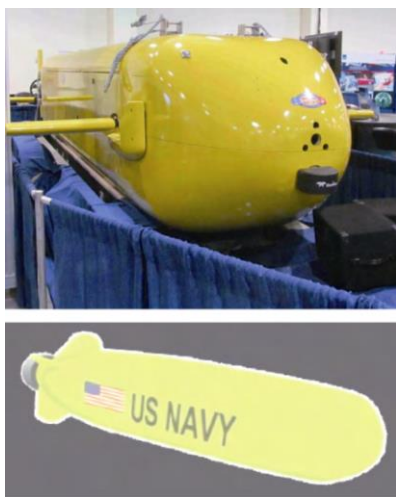
图 18 美海军大直径创新型无人水下航行器原理样机
