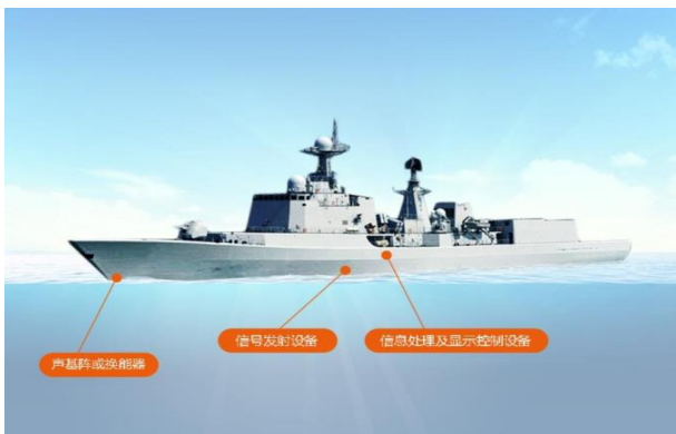
图 8 水声信息装备在水面舰艇中的应用
