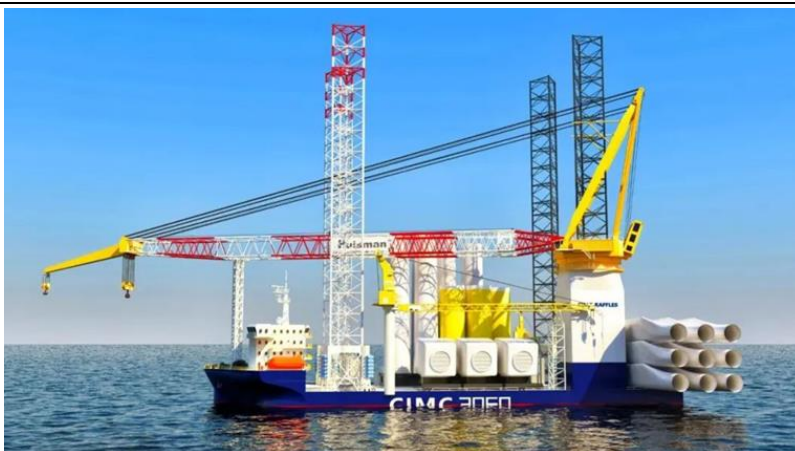
图 51: “博强3060”自升式风电安装船
