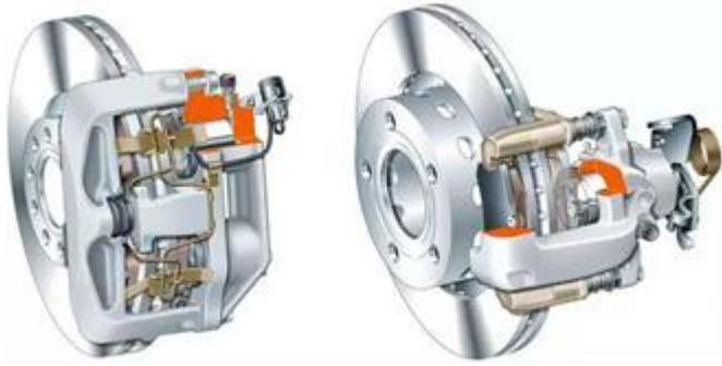
图表 19：汽车刹车系统结构示意图
