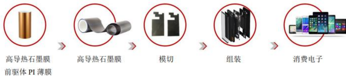
图 3：高导热石墨膜前驱体 PI 薄膜应用示例
