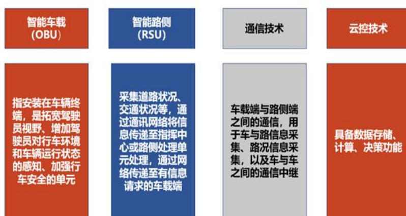
图 27: 车路协同建设核心软硬件搭配
