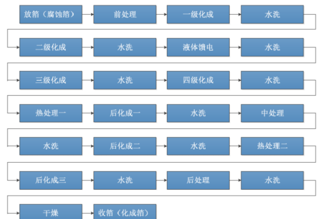
图表23：化成箔的生产工艺流程
