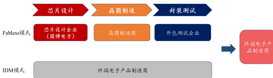
图 25、集成电路企业 Fabless 模式和 IDM 模式示意图
