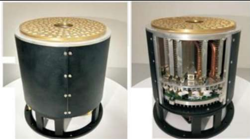
图2：Ka 波段超稀疏非谐波相控阵天线样机
