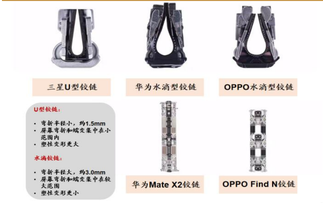
图 32: U 型铰链和水滴型铰链示意图 (1)
