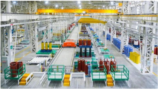
图 40：金盘科技海口高端干式变压器数字化工厂
