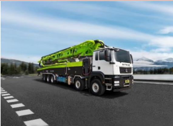
图47.混凝土泵车图示
