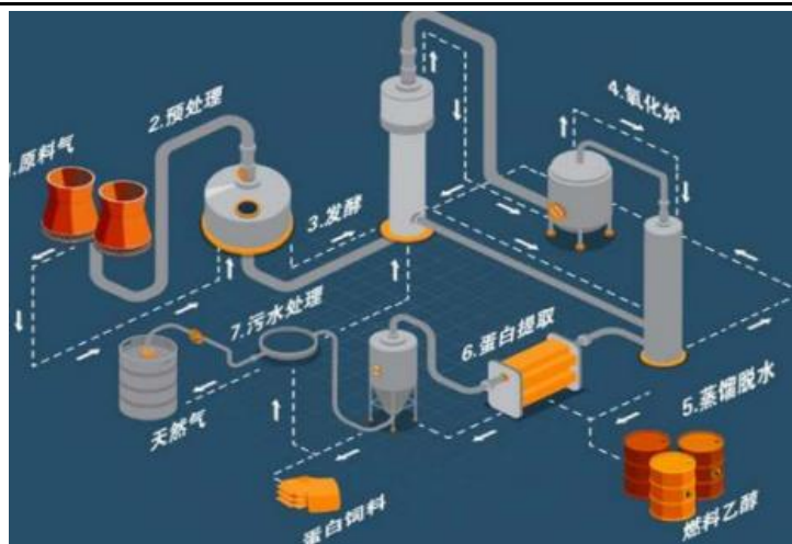
图20: 工业尾气制乙醇流程图
