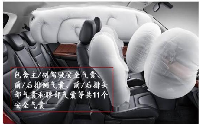
图26: 比亚迪汉的气囊配置情况
