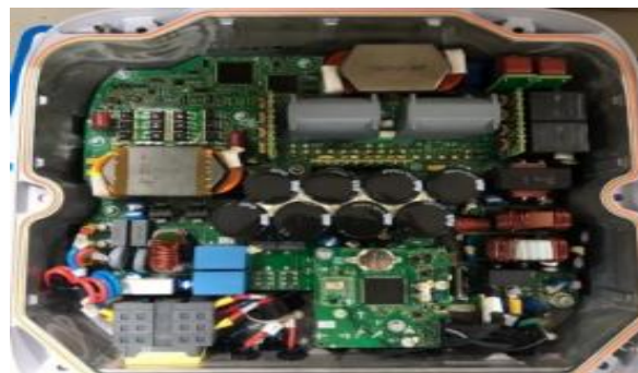
图 66：光伏逆变器内部拆解图
