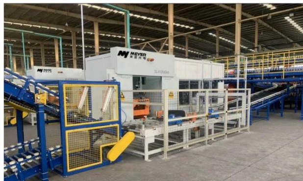
图表 50：玲珑轮胎美亚轮胎 X 光检测机使用现场
