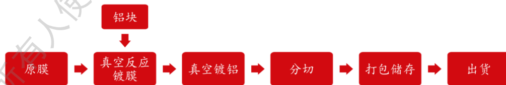
图表 26：复合铝膜工艺流程
