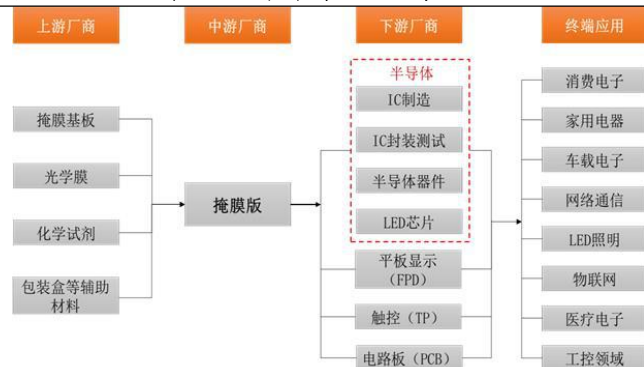
图 22、掩膜版广泛用于半导体各生产流程
