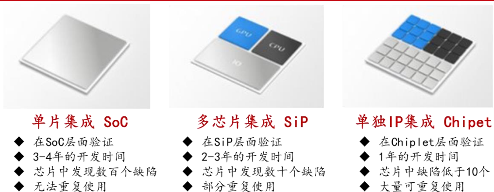
图表21：Chiplet 技术与 SoC、SiP 技术比较
