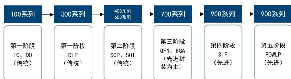
图1：公司封装技术发展阶段、对应封装形式与产品体系
