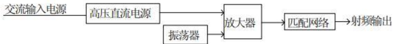
图 19 射频电源原理
