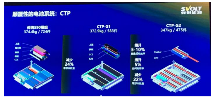
图表 11 蜂巢能源 CTP 技术示意图
