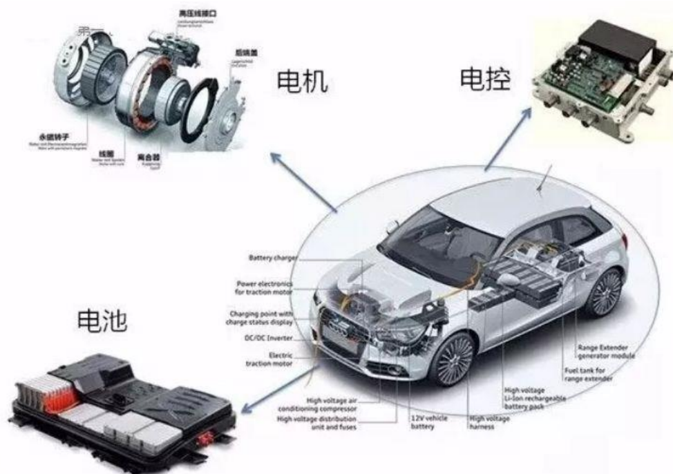
图表 5 新能源汽车三电系统
