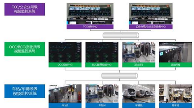
图 35：城市轨道交通视频监控解决方案系统架构图
