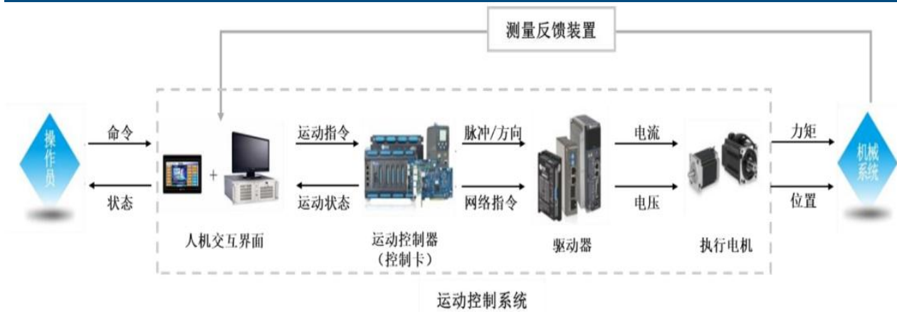
图表3：典型的运动控制系统构成
