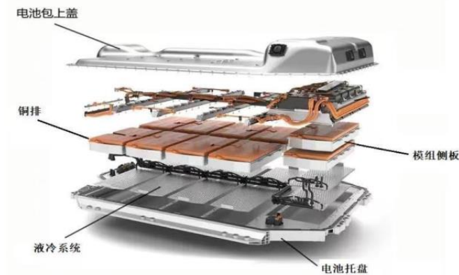
图 7：电池箱体结构
