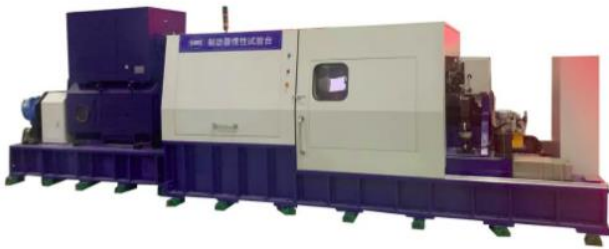
图表 28：商用车惯性试验台控制精度达国外水平
