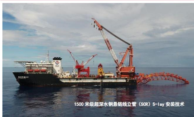
1500 米级超深水钢悬链线立管 (SCR) S-lay 安装技术
