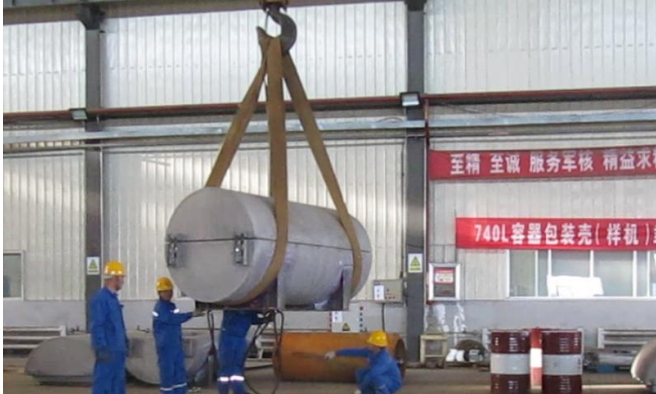
图表 28: 中核嘉华成功研制国产化 QY740 六氟化铀运输容器
