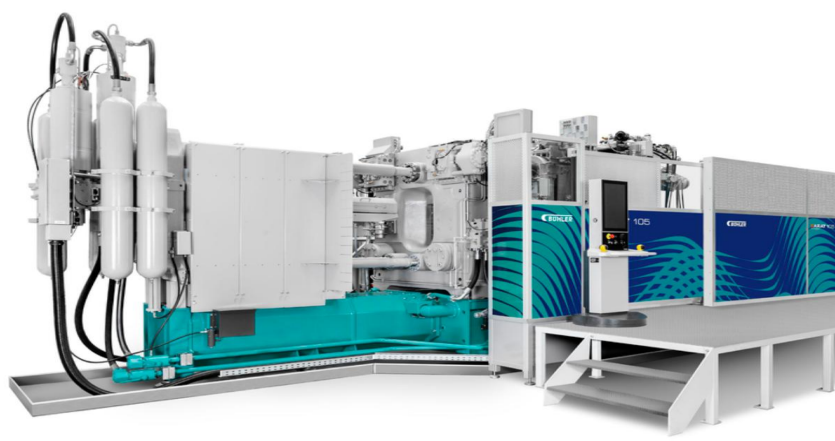
图 20：布勒 Carat 两模板压铸机示意图
