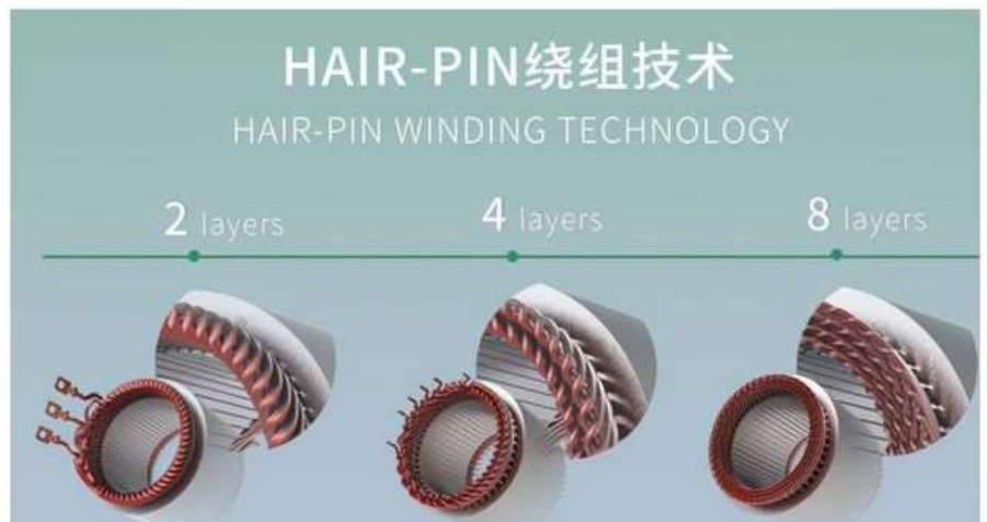
图 16: 扁线电机的 HAIR-PIN 绕组技术
