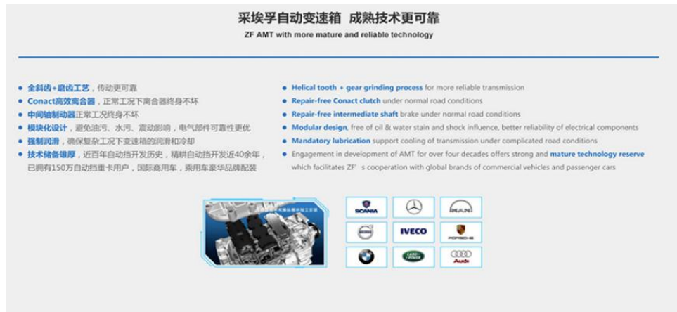
图 28：采埃孚福田 AMT 变速箱特征
