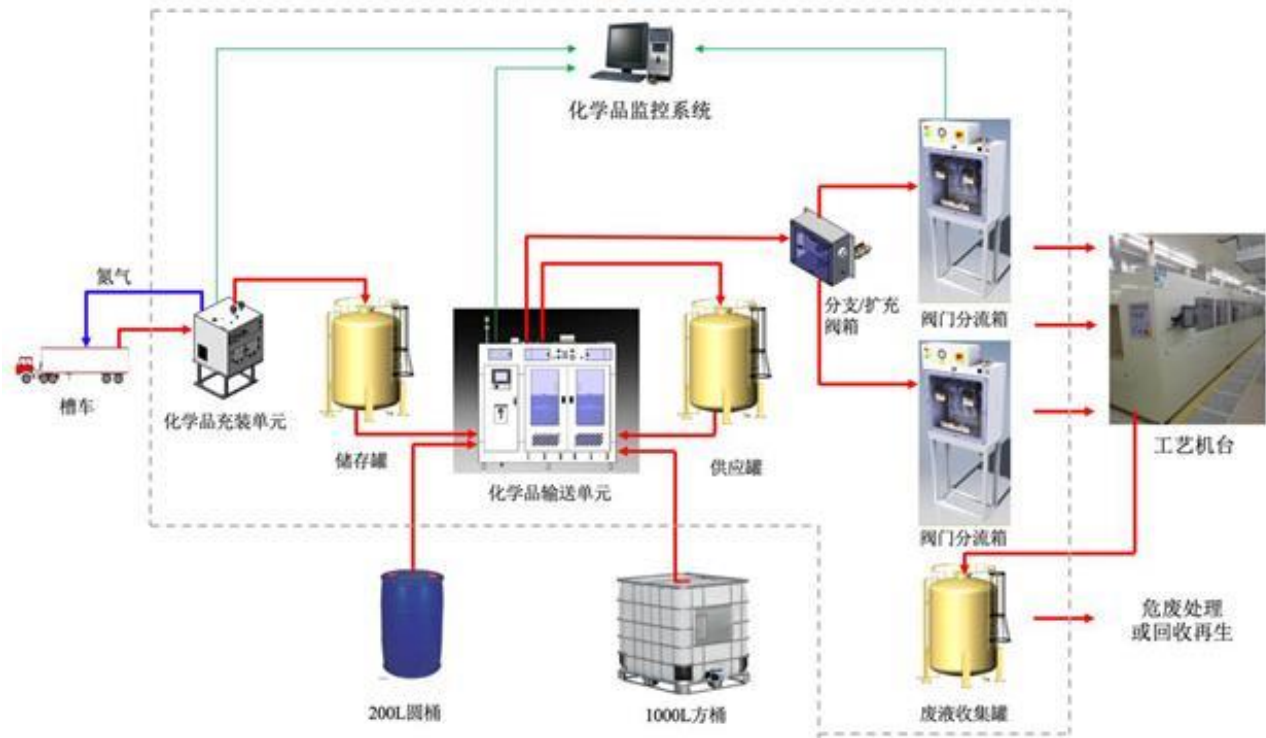
图28：化学品供应系统示意图
