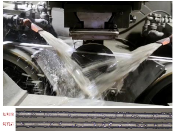
图2：黄河旋风金刚线切割后线径磨损均匀
