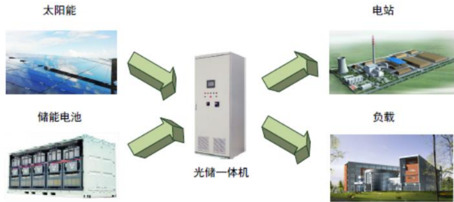
图28：“光储一体化”产品有效增强了光伏发电灵活性
