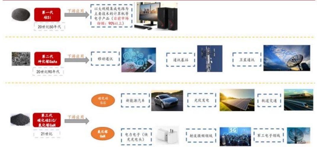
图22: 半导体材料经过 3 代的发展, SiC 为第三代半导体材料的核心
