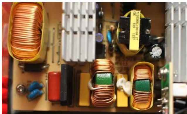
图 42: 电感元件在光伏逆变器中示意图
