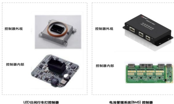
图26: LDM 与 BMS 控制器硬件结构具有相通性
