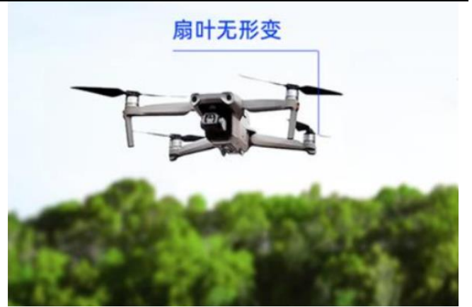
图表90. 全局快门 CIS 下无人机扇叶无变形
