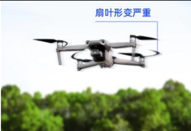
图表89. 卷帘快门 CIS 下无人机扇叶形变严重
