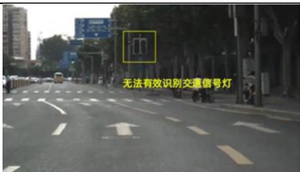
图表97. 无 LED 闪烁抑制的图像传感器成像
