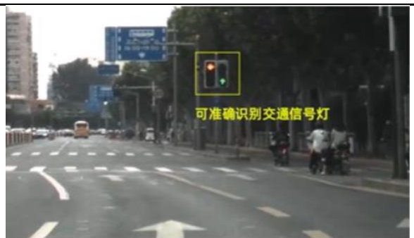
图表98. 有 LED 闪烁抑制的图像传感器成像
