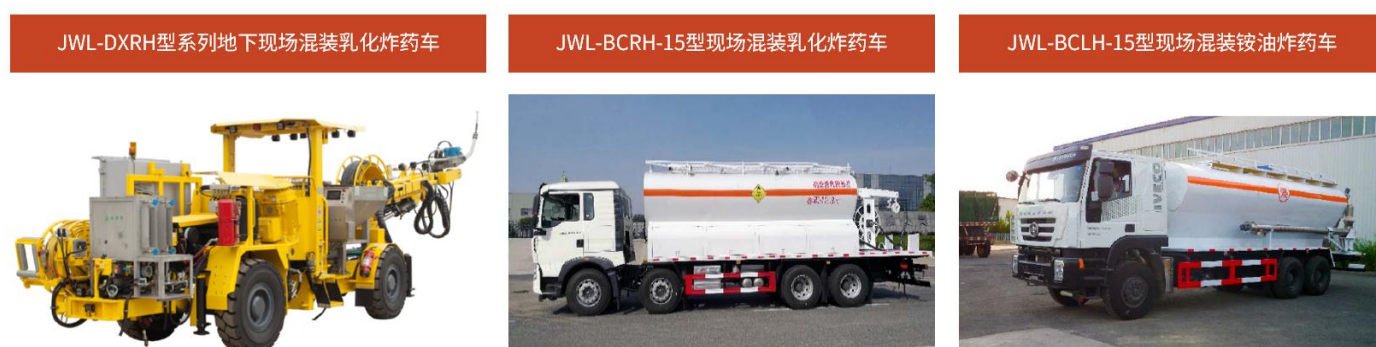
图 10：公司的混装炸药车产品
