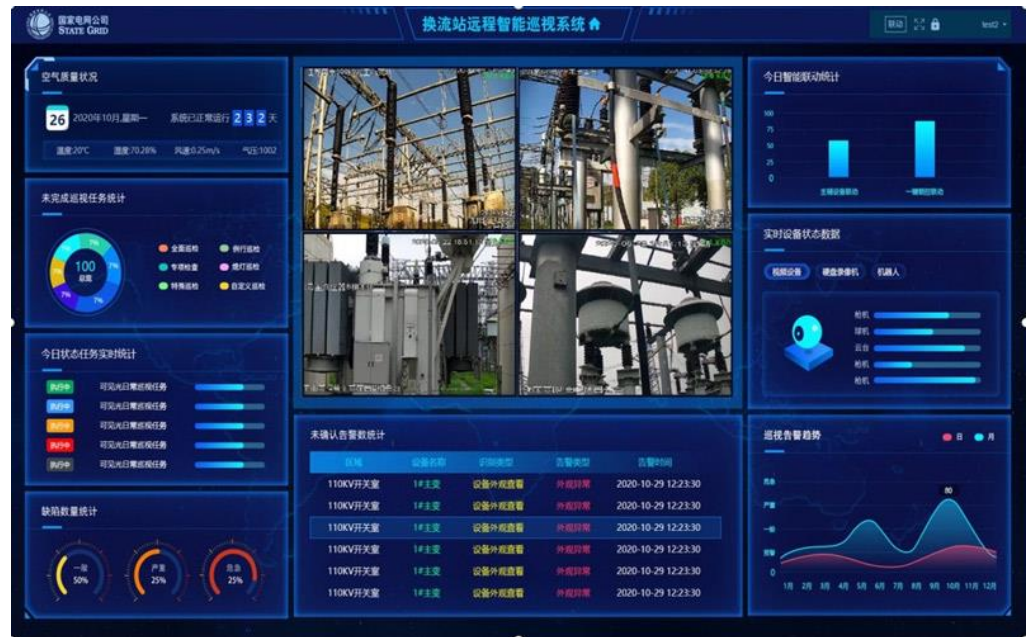
图表 39: 换流站远程智能巡视系统
